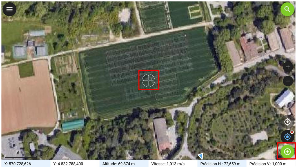
Figure 39 : Prise d'un nouveau point GPS déporté en utilisant un fonds d'image pour localiser la parcelle
